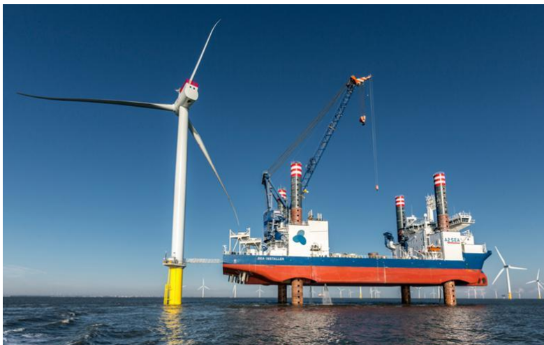
Figura 16 – Fundação fixa Monopile – Central eólica offshore Gemini, costa da Holanda (Ivan Shumkov, 2015)
