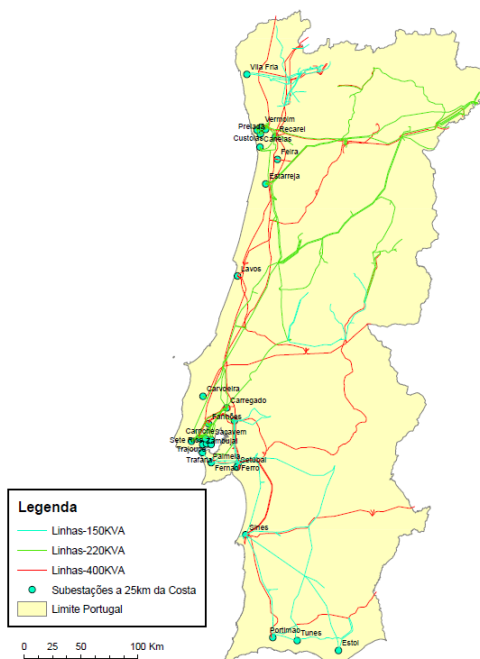
Figura 24 - Rede Nacional de Transporte e Subestações a 25 km da linha de costa.
